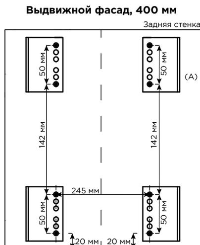
2. Установите основание корзины (С) на выдвинутые направляющие (А), зафиксировав дальнюю часть основания крючком, а переднюю часть винтами М4х6.
