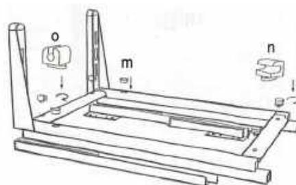
4. Сделайте разметку фасада под крепления согласно заданным размерам и установите их, зафиксировав винтами.
